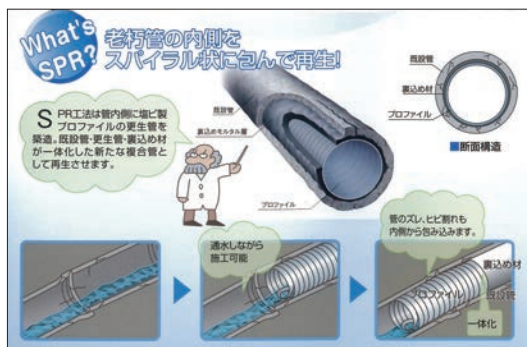
SPR工法（下水道管更生技術）
