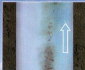
アイスピグが夾雑物を包み込み 垂直搬送する状況のイメージ
